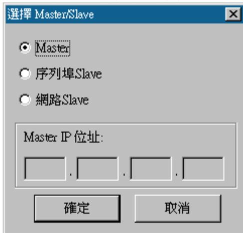
a. Master：設定您的電力管理大師 2000 為 Master。Master 可以讓遠端 Slave 連接，一旦電力事件發生時，Master 會將事件訊息傳遞給 Slave，讓 Slave 知道發生什麼事，並啟動保護動作。
